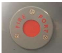
Port incendie - situé du côté du port de la console
